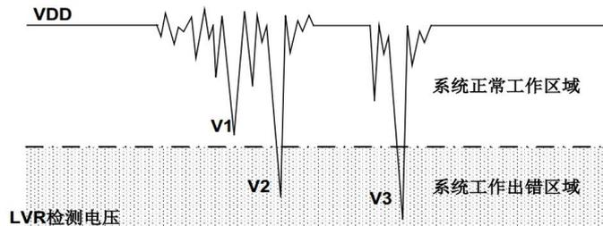
电压跌落可能会进入系统死区。系统死区意味着电源不能满足系统的最小工作电压要求。上图是一个典型的掉电复位示意图。图中，VDD 受到严重的干扰，电压值降的非常低。虚线以上区域系统正常工作，在虚线以下的区域内，系统进入未知的工作状态，这个区域称作死区。当 VDD 跌至 V1 时，系统仍处于正常状态；当 VDD 跌至 V2 和 V3 时，系统进入死区，则容易导致出错。以下情况系统可能进入死区：
